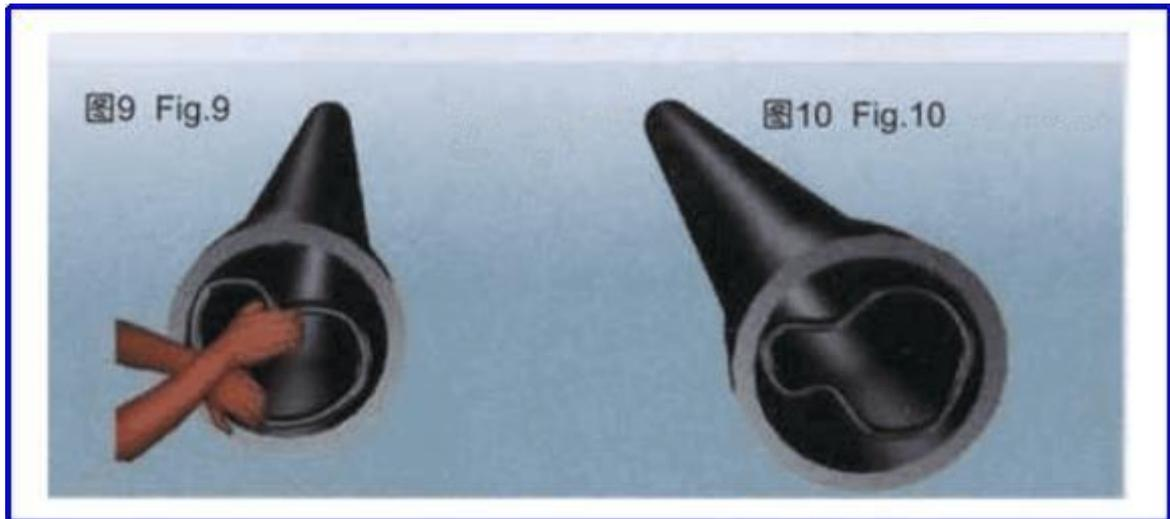
调整球墨铸铁管的水平位置，进行校正，移动插口，将前端少许插入承口内。插入管应尽量悬空，沟壁、沟底的石块等有碍插入的东西要清除。
