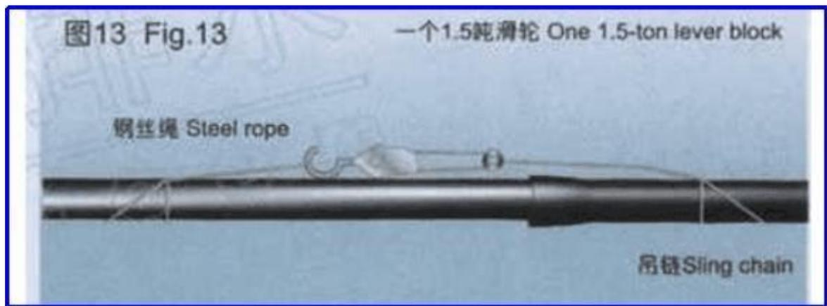
插口处划有二条标志线，拉入到已看不见第一条线，而只看见第二条线的位置为止。接合完毕后，必要时用塞尺检查橡胶圈是否在正常位置。管子安装不理想时，应将管子分离后，再重新安装。
