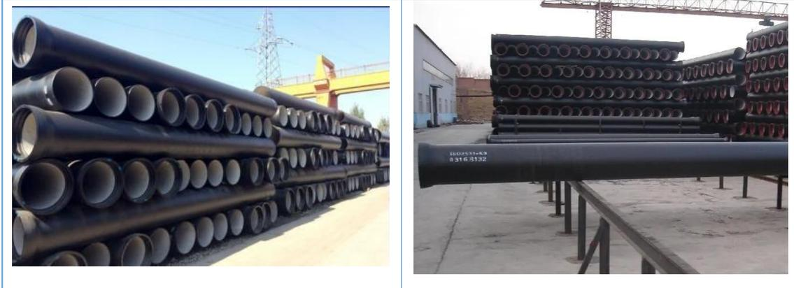
球墨铸铁管堆码的原则要求是在码垛稳固、确保安全的条件下，做到按品种、规格码垛，不同品种的材料要分别码垛，防止混淆和相互腐蚀。
