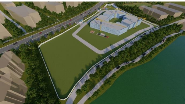
主体结构施工阶段平面布置图及 BIM 模拟
